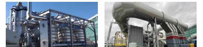
沸石吸附 + 觸媒式焚化爐 (CTO) 沸石轉輪 + 蓄熱式焚化爐 (RTO)
