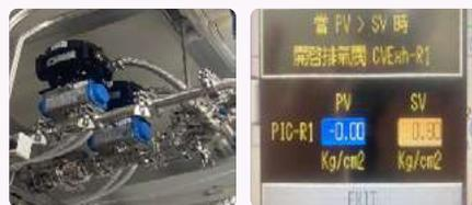
PLC 控制，壓力過高自動排氣及防範真空及排氣閥同開。
