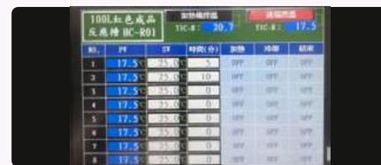
PLC 之 HMI 系統，計時及溫控功能，並於第一時間執行跳脫做動及警報
