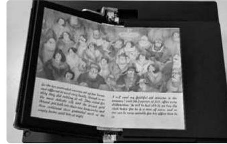
▲ 內建前光照明的 10.3” 彩色印刷（E Ink Kaleido™）可摺疊電子紙顯示器
