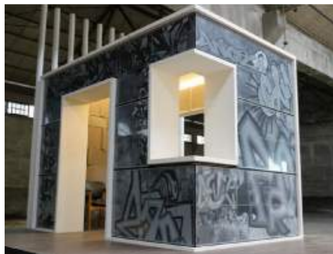
由32片大尺寸電子紙顯示看板拼接而成的電子紙屋
